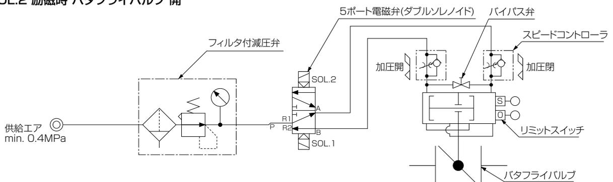
→SOL.1に一度励磁させると、万ー消磁してもSOL.2に励磁しない限りその状態を保持します。
