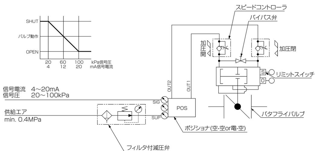
→供給エアが確保された状態で入力信号が消失すると、バタフライバルブは全閉になります。
