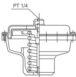
回転弁専用のアクチュエータである。ダイヤフラムステムの先端がフリーになっており、アクチュエータの直線運動をリンク接続により弁軸の回転運動への変換がスムーズに行われる。
